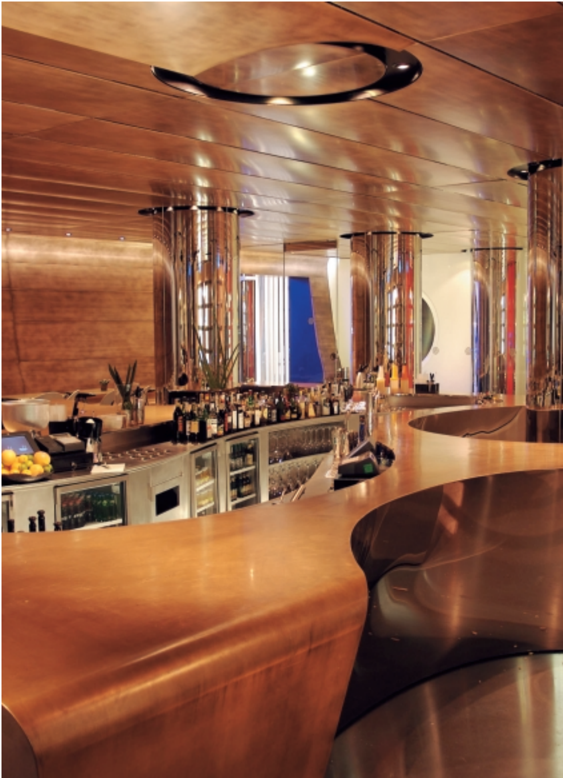
Una veduta del bar dell'albergo, il cui soffitto e la parete di fondo sono ricoperti da una "pelle" di bronzo. Si noti l'invisibilità dei terminali di diffusione dell'aria che sono costituiti da elementi lineari ad una feritoia, sapientemente disposti per non essere notati.
