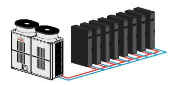
CONFIGURATION WITH REDUNDANCY (N+1)
